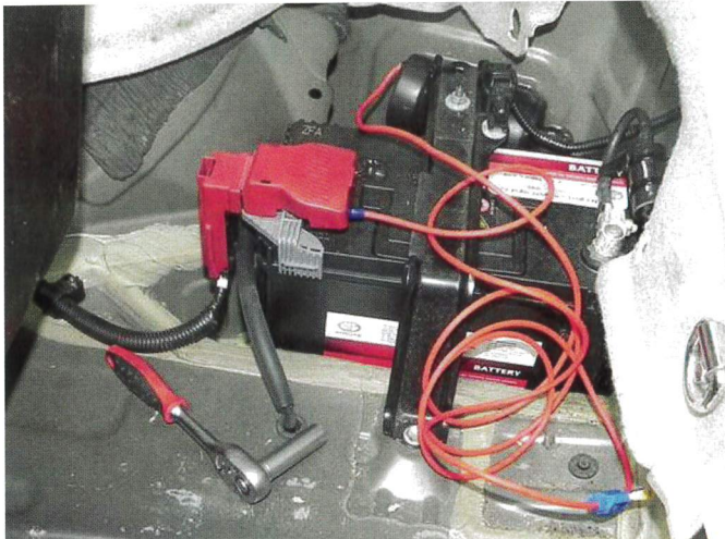
Einbau der Perlix-8-Röhre mit nach rückwärts weisender Metallkugel (oben) hinter der Batterie. Das rote Kabel von der Röhre führt - sicherheitshalber - über eine Sicherung (im blauen Sicherungshalter) zum Pluspol der Batterie. Über das Kabel fließt kein Strom, weil die Kunststoffröhre keine Verbindung zur Masse hat. Das gesamte Kabel wird hinter der Batterie versenkt. Die zusätzliche Länge kann für Einbauten in anderen Autos nützlich sein, wo sich z.B. die Batterie im Motorraum vorne befindet und zur Perlix-8-Röhre nach hinten geführt werden muss.
